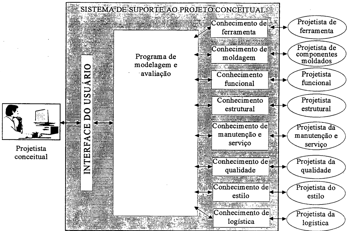
Figura 4.4 - Ambiente computacional para o projeto conceitual do produto sob o enfoque da engenharia simultânea [55].
