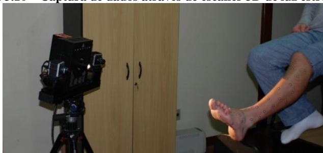
Figura 3.10 – Captura de dados através de escâner 3D de luz estruturada
