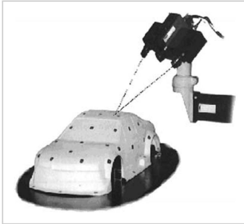
Figura 2.5 – Operação de escaneamento de um modelo de carro em escala utilizando um equipamento sem contato
