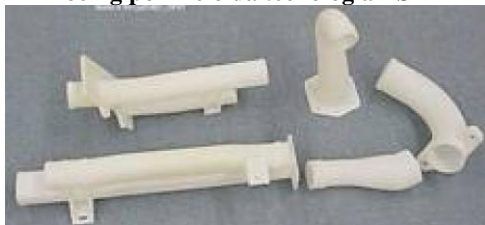
Figura A.1 – Dutos de ar fabricados pela Boeing por meio da tecnologia LS
