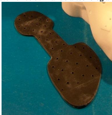
Figura 3.27 – Sola fabricada em material elastomérico utilizando a tecnologia 3DP
