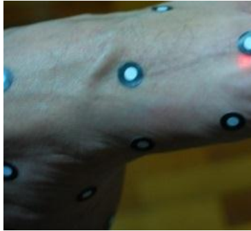
Figura 3.11 – Targets utilizados para facilitar o processo de alinhamento de nuvens de pontos
