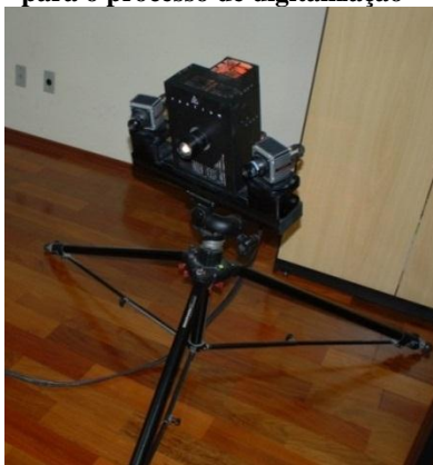
Figura 3.9 – Escâner tridimensional utilizado para o processo de digitalização
