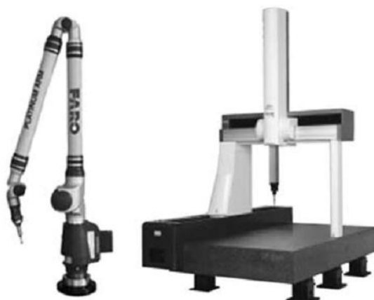
Figura 2.4 – Apalpadores acoplados a diferentes equipamentos
