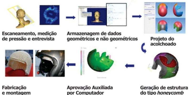
Figura 2.19 – Processo de criação de capacetes personalizados
