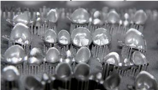
Figura A.5 – Componentes para restaurações dentais fabricados em CoCr por meio da tecnologia DMLS
